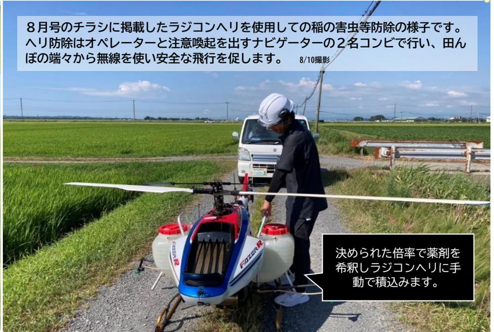
8月号のチラシに掲載したラジコンヘリを使用している稲の害虫等防除の様子です。ヘリ防除はオペレーターと注意喚起を出すナビゲーターの2名コンビで行い、田んぼの端々から無線を使い安全な飛行を促します。 8/10撮影
